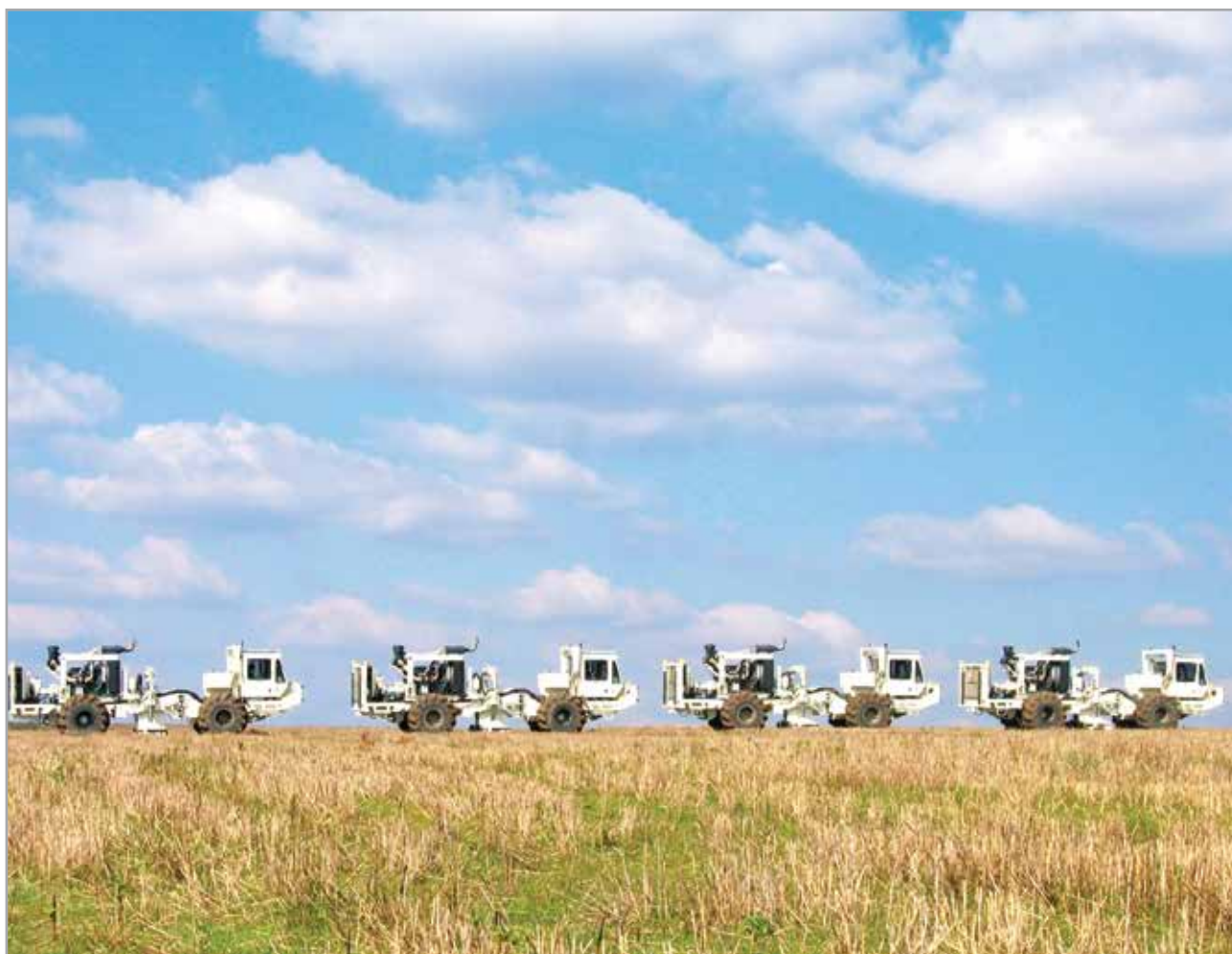
Ново поколение сеизмични Вибратори I/O AHV - IV 362 за 2-D и 3-D сеизмични изследвания
